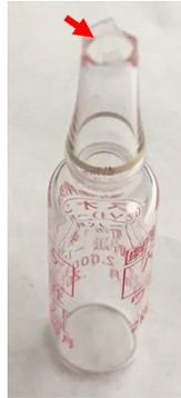
原因として、ガラスアンプルを火炎で封じる際に目視確認できないほど微小な穴（ピンホール）が生じ、そこから液体窒素がアンプル内に流入し、加温した際に液体窒素が気化膨張することによりその圧力で破裂する可能性があります。
